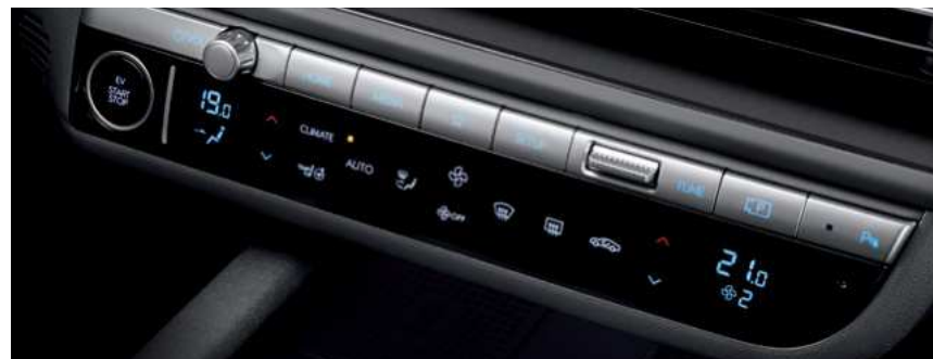
מערכת בקרת אקלים דיגיטלית מפוצלת מערכת בקרת האקלים מצוידת במערכת דו-אזורית המאפשרת שליטה מדויקת בטמפרטורה.
