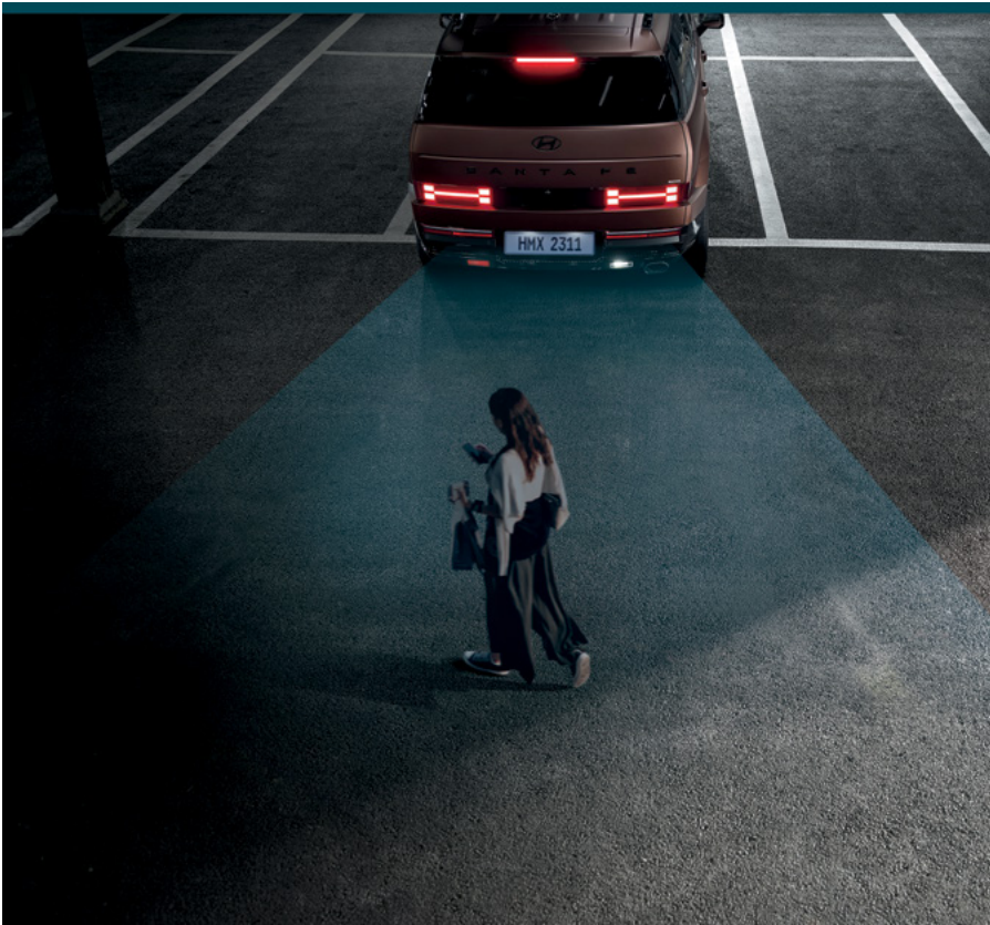
מערכת אקטיבית להתראה ומניעת התנגשות בעת כניסה ויציאה מחניה (PCA)
